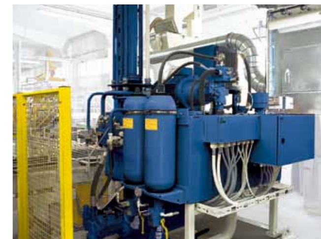
高性能液压装置, 泵和蓄能器有效缩短了成型周期
