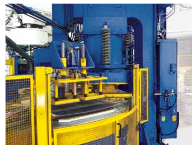
独特的门式结构确保了最大的加压效率
