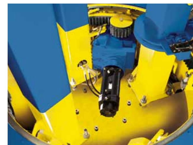
转盘伺服传动装置确保了最优的加速和制动性能
