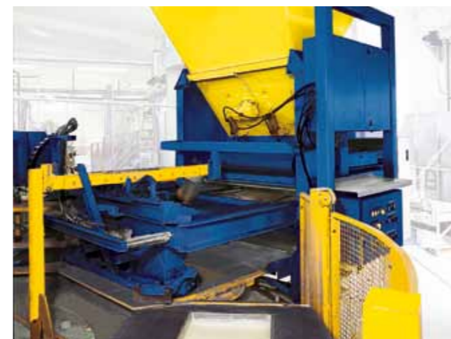
带有搅拌给料箱的底料布料装置精确确保了板材厚度
