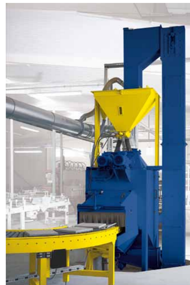
喷丸加工线：创造完美外观，赋予板材防滑特性
